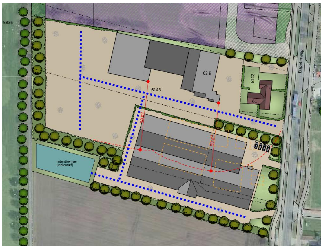
Figuur 2: Structuur berging/afvoerleiding projectgebied
