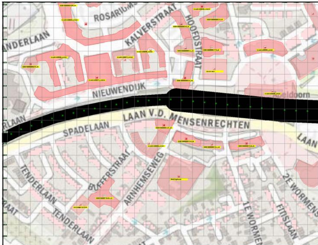
Figuur 4.1 Basisnet afstand/ PR 10-6 (1 meter)
