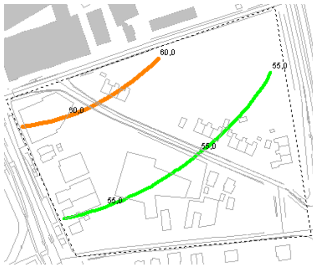
afbeelding 4.3. Geluidcontouren piekemissies Eurocast (h=10 m)
