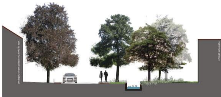
4. Principeprofiel Beurtvaartstraat ter hoogte van het activarium en de Griftstraat, schaal 1:100
